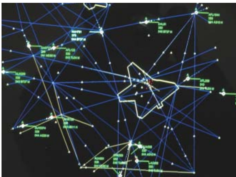
Cyfrowe zobrazowanie systemu wieloradarowego śledzenia i przetwarzania danych AMS 2000+.
